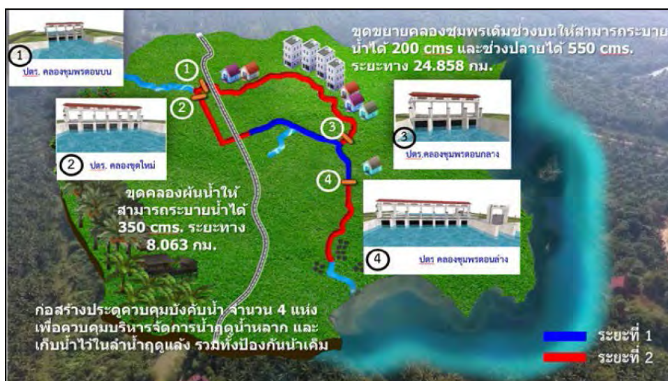
รูปที่ 2.2-5 งานขุดคลองผันน้ำคลองชุมพรและงานขุดขยายคลองชุมพรเดิมช่วงต้นและช่วงปลาย
