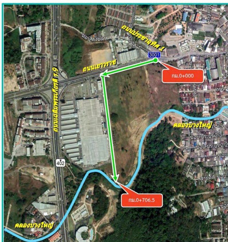
รูปที่ 2.2-9 พื้นที่ก่อสร้างท่อระบายน้ำ คสล. บริเวณถนนประชาอุทิศหลังโลตัส - คลองบางใหญ่ (DR5)
