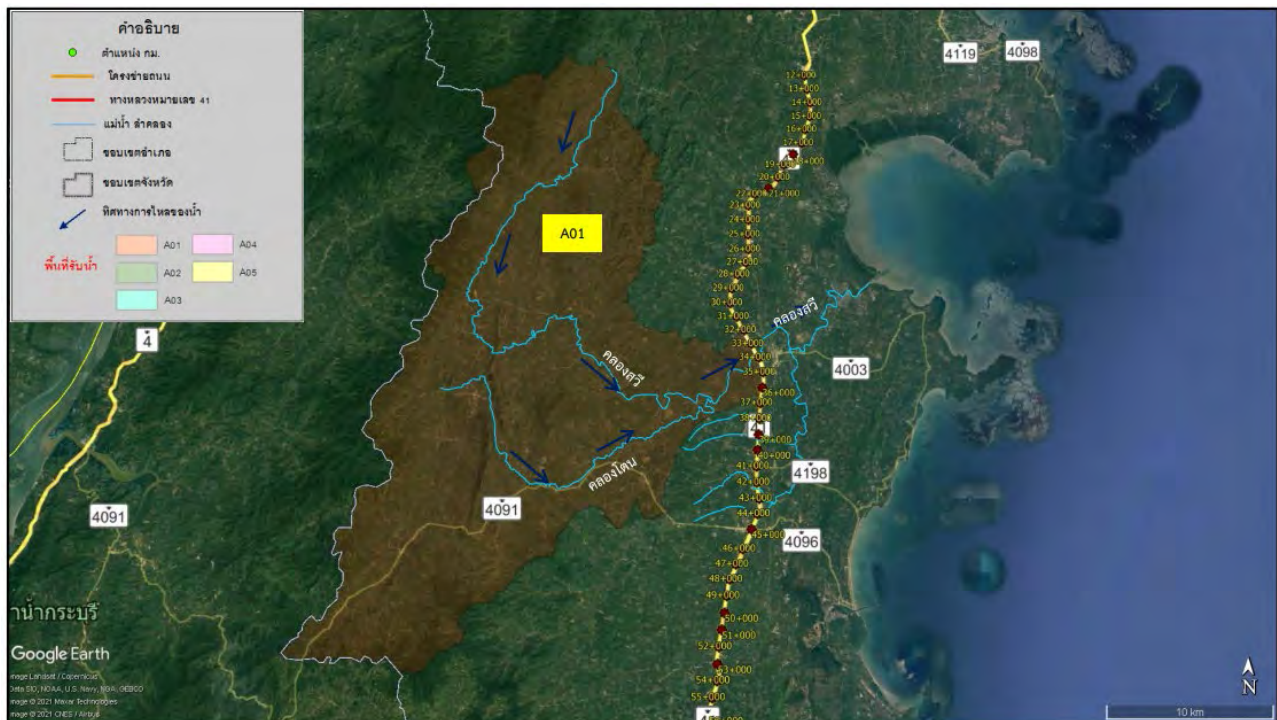
รูปที่ 2.4-2 พื้นที่รับน้ำ A01 ทางหลวงสาย 41 ระหว่าง กม. 32+000 – กม. 44+865
